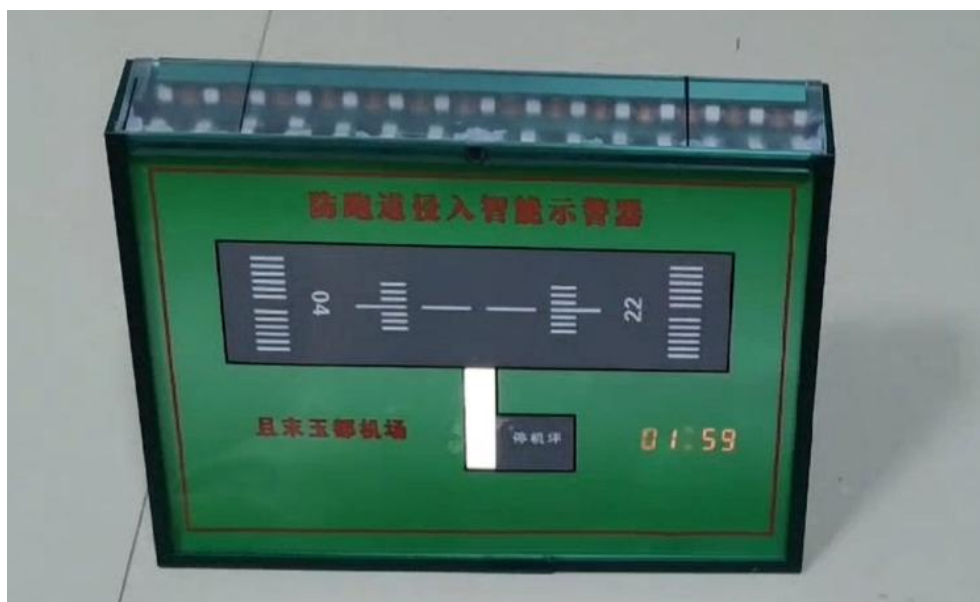
图八：图示为跑道被占用，监测系统识别到管制员指令存在冲突，红灯闪烁 语音提醒
