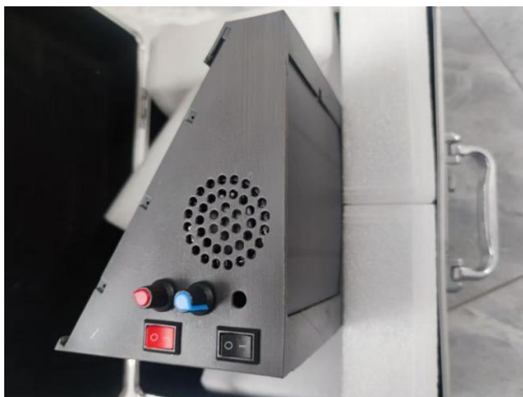
图五：灯光、音量、开关控制模块（右后侧图）
