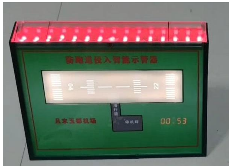
图八：图示为跑道被占用，监测系统识别到管制员指令存在冲突，红灯闪烁 语音提醒
