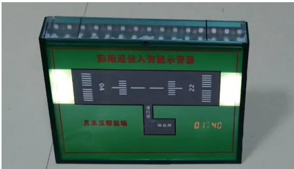
图六：设备主体为 PLA 材料（正面示意图），设备在各种环境下均能正常运行，图示为跑道的一边及五边被占用，右下角时钟为占用时长
