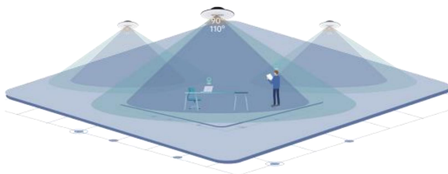
蓝牙高精度定位技术原理示意图
