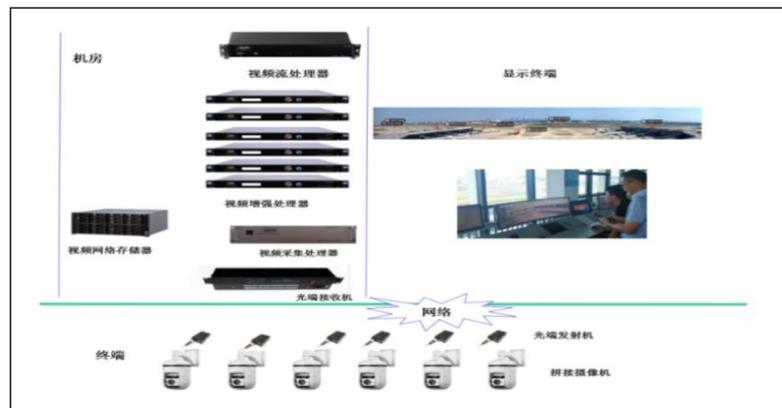
图9 低空飞行监视系统在某机场塔台应用场景
