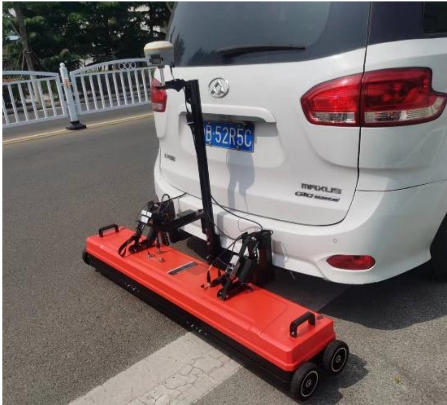
图 1 三维阵列探地雷达系统整体安装图
