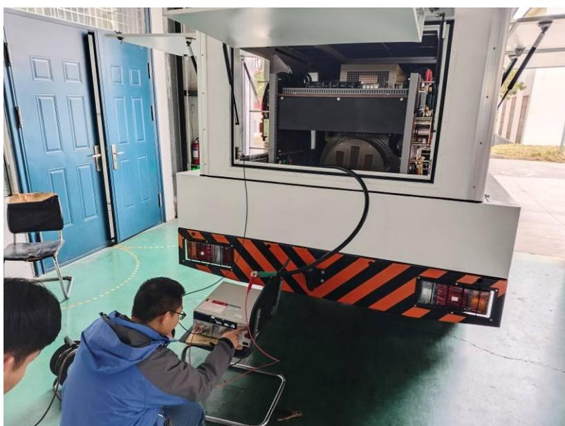
照片 E6 绝缘电阻检测
