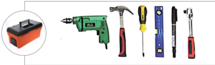
(电钻、榔头、十字螺丝刀、水平尺、记号笔、扳手)
